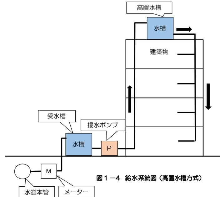
図 1-4 給水系統図 (高置水槽方式)
