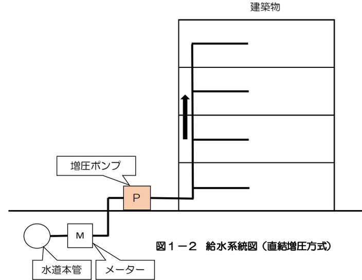
図 1-2 給水系統図 (直結増圧方式)
