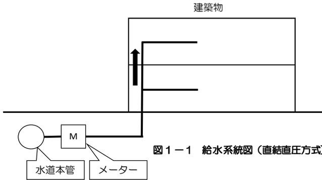
図 1-1 給水系統図 (直結直圧方式)
