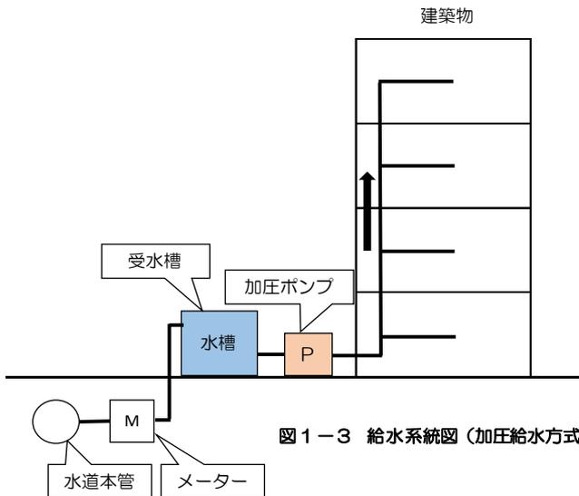
図 1-3 給水系統図 (加圧給水方式)
